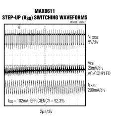
MAX8611 STEP-UP (V<sub>SU</sub>) DUAL SKIP SWITCHING WAVEFORMS
