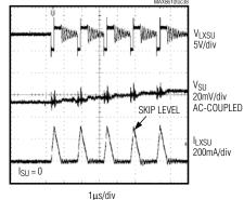
MAX8611V STEP-DOWN (VAFE) SWITCHING WAVEFORMS
